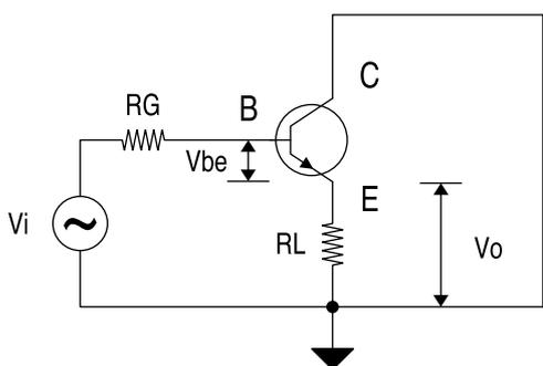
(b) Circuito in alternata di uno stadio a inseguitore di emettitore e suo modello equivalente di piccolo segnale (Circuito di Giacometto + impedenze esterne)
